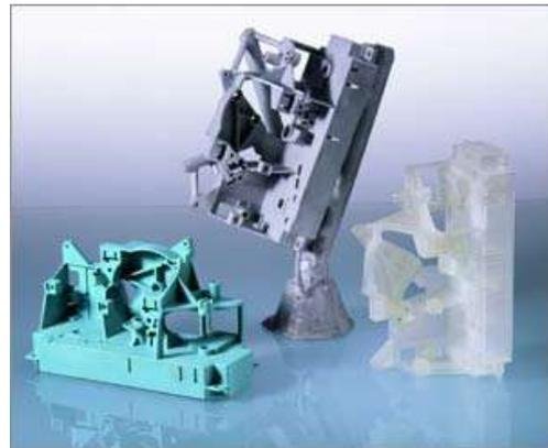
Schnell und in bester Qualität fertigen wir komplexe und detaillierte Gussteile im Metal-Cast-System. Hierzu werden die nach 3D-Daten hergestellten Lasersinterenteile aus Polystyrol oder Wachsmodelle aus dem Vakuumgießen in eine Keramikmasse eingebettet.
