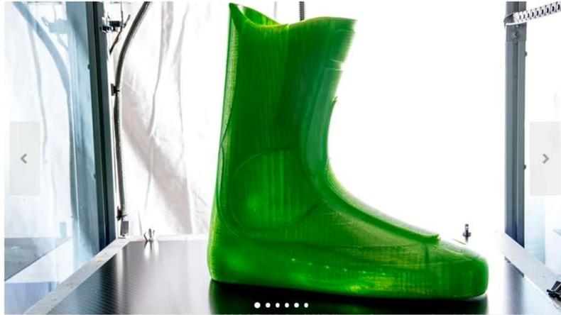
Weicher Innenschuh aus TPU mit Fused Deposition Modeling (FDM) ©Tailored Fits AG
